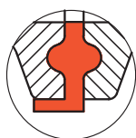
Деталь уплотнения Detail těsnění
